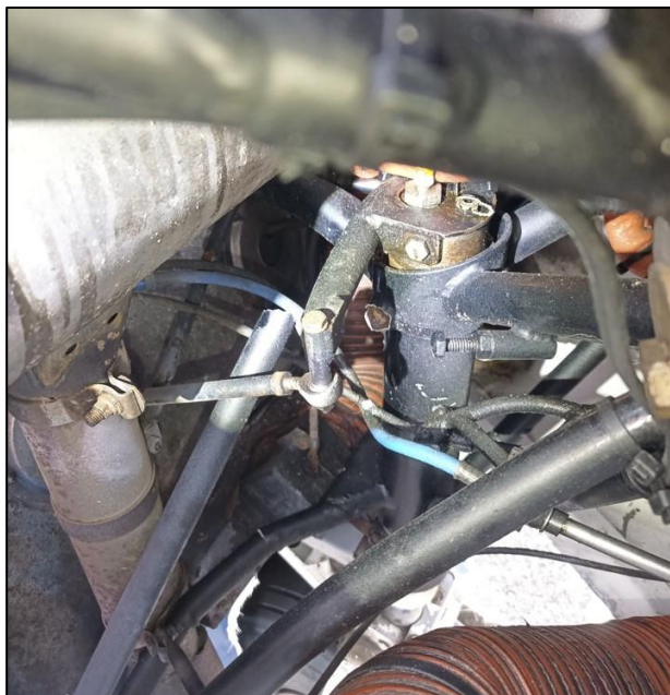
Foto 3. Beskadiget næsehjulsunderstøtts- og motorophæng.
