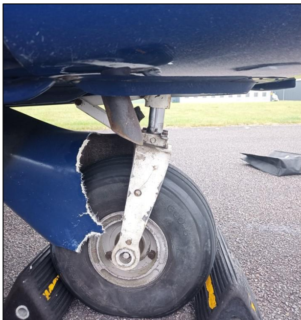
Foto 1. Bukket næsehjulsunderstel og beskadiget hjulskærm.
